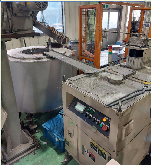
半凝固用スラリーを作る電磁攪拌機
