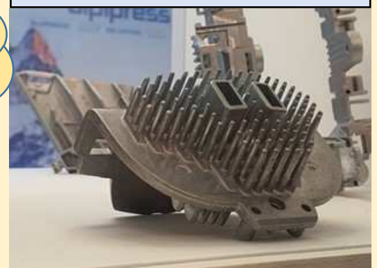
フィンがピン形状のヒートシンク
