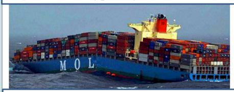
6月17日正午、船体中央部に亀裂が生じ、 ホールド内への浸水により自力航行不能に陥りました。
